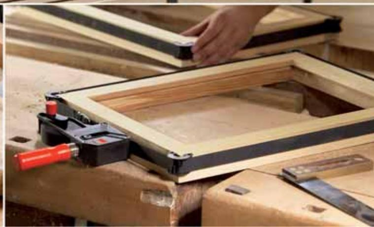
**Двусторонний равномерный зажим без перекоса**
